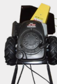
Agregat boczny do obrzeży - Side cutter for borders
