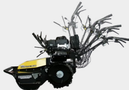
W pełni składany uchwyt do transportu - Full closure handlebar for transportation
